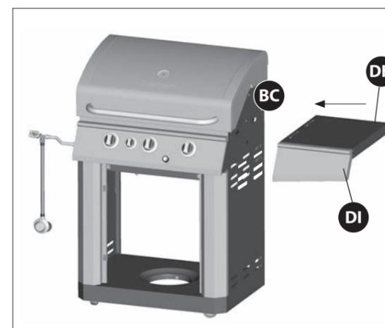
**CONSEIL :** Pour positionner la tablette latérale droite, insérez les deux crochets de l'ensemble de la tablette latérale dans les deux supports situés sur le panneau latéral droit supérieur (BC).
