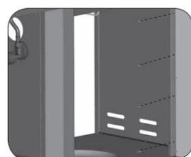
b. Montez la porte (EF) sur le support droit (ED), tel qu'indiqué sur le schéma B, à l'aide des vis fournies.
