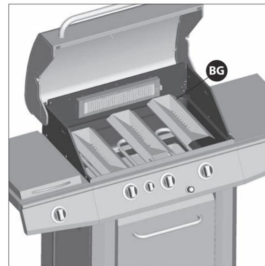
Positionnez d'abord les brise-flammes (BG) dans le compartiment des brûleurs.
