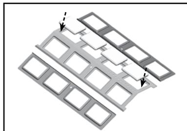
4. Repositionnez le cadre en acier inoxydable et repositionnez la goupille de sécurité pour barrer en place.
