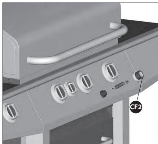
Dévissez le bouton d'allumage électronique (CF2) et insérez une pile AA dans le compartiment à piles, le côté positif faisant face vers l'extérieur.
