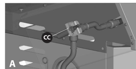
a. Retirez les ferrures préassemblées sur le support de la valve du brûleur latéral (CC) tel qu'indiqué sur le schéma A. Insérez la tige de manœuvre du brûleur latéral à travers l'arrière de la bordure de la tablette latérale gauche (DB). Assemblez la valve du brûleur latéral (CC) sur la bordure de la tablette latérale (DB) à l'aide des ferrures précédemment retirées.
