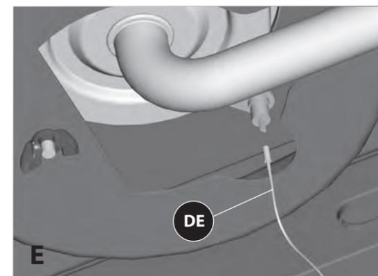
e. Attachez l'extrémité du fil à électrode du brûleur latéral (DE) à la partie inférieure de l'électrode du brûleur latéral, tel qu'indiqué sur le schéma E.
