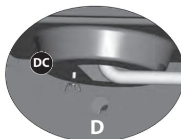
d. À l'aide de l'écrou à oreilles fourni, montez le brûleur latéral (CC) sur le plateau d'égouttement du brûleur latéral (DC), tel qu'indiqué sur le schéma D.
