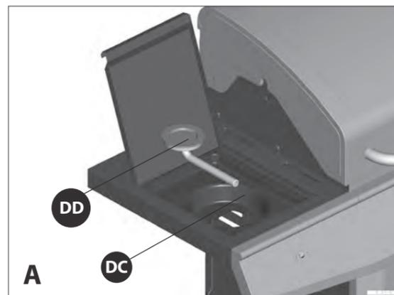
a. Mettez le brûleur latéral (DD) en place à travers l'ouverture du plateau d'égouttement du brûleur latéral gauche (DC).
