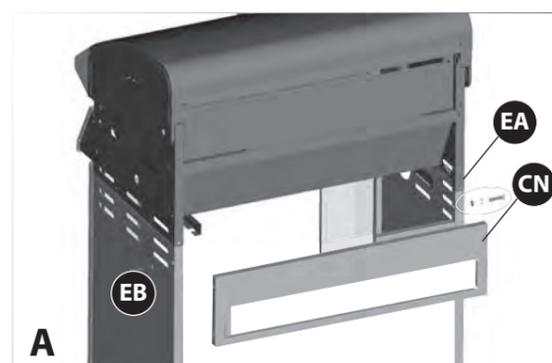
Fixez le panneau arrière supérieur (CN) aux panneaux latéraux droit et gauche (EA et EB).
